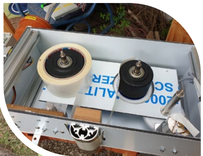
Mit dem speziell entwickelten Röhrensystem des DoMoS (links) lassen sich Gartenschläfer erfassen und langzeitbeobachten. Wenn die Tiere durch die Röhren laufen, bleiben an einem Klebeband Haare von ihnen hängen (rechts).
