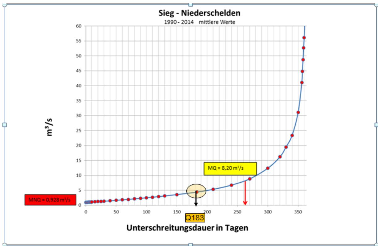
Das bedeutet, dass der mittlere Abfluss nicht zum Orientierungswert Phosphor passt, der als Jahresmittelwert angegeben ist. Besser würde dazu der Abflusswert  $Q_{183}$  passen. Dieser Abfluss wird an 183 Tagen, also - an der Hälfte der Jahrestage - unter- wie überschritten. Dieser Wert entspricht in etwa der Hälfte (!) des MQ-Wertes.
